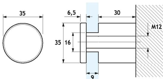
Distanziale cilindrico con collare senza vite in vista
